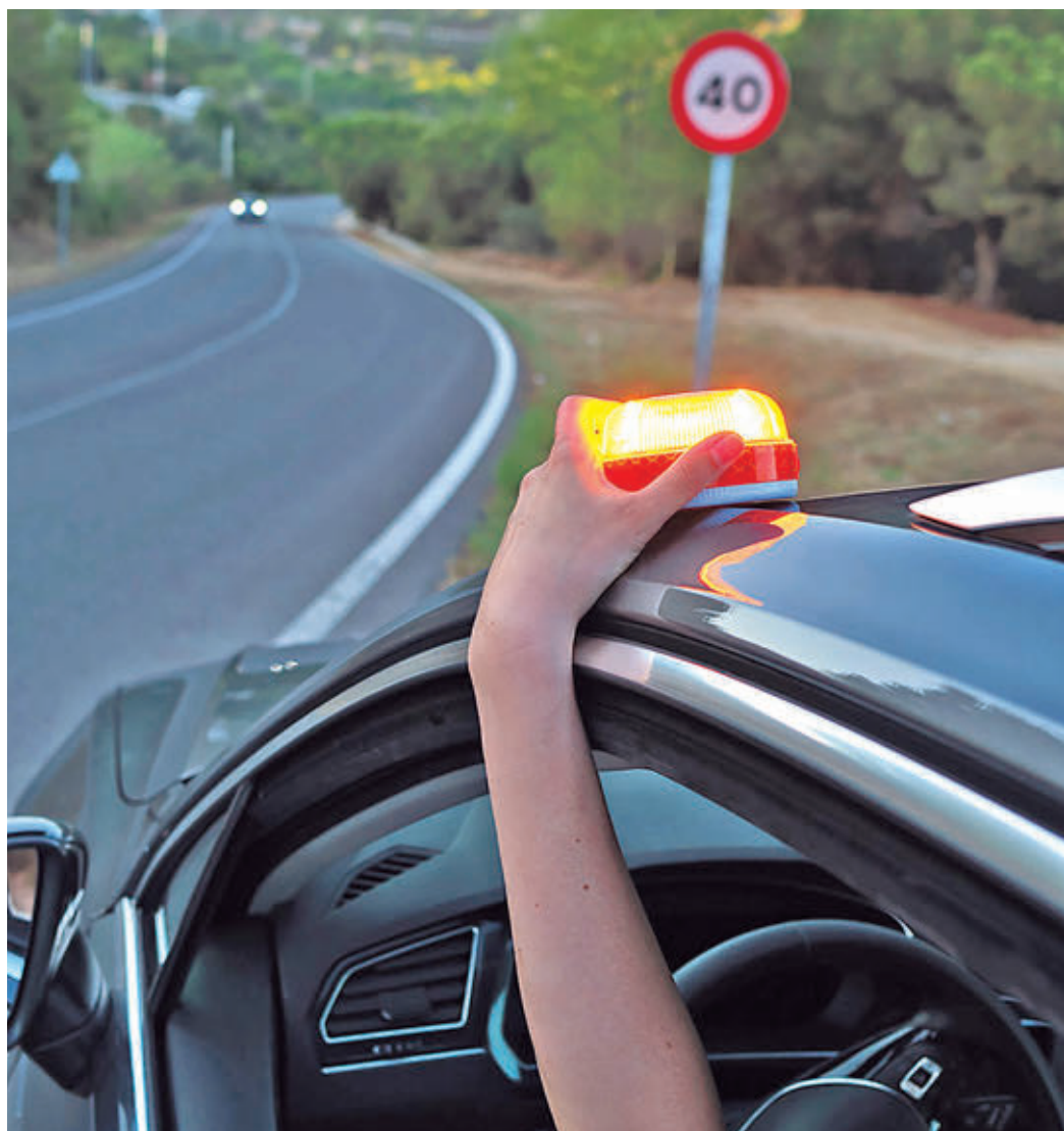
Una conductora coloca una baliza V16 en el techo de su vehículo DGT
